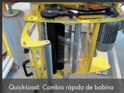
QuickLoad: Cambio rápido de bobina
